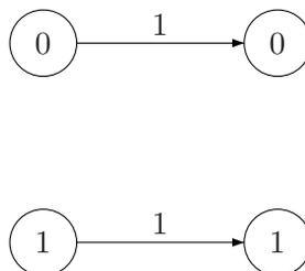
Jedes Zeichen wird mit Wahrscheinlichkeit 1 korrekt übertragen. Somit gibt es hier keine Störungen, und die Kapazität wird für  $\beta = 0$  maximal.
